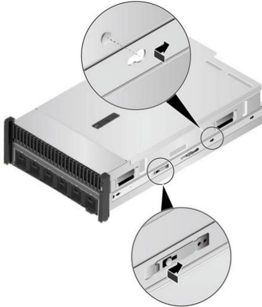
3. 至少四人从两侧将设备抬起，使设备上的内轨对准抱轨轨道，同时将设备推入机柜，如图 5-15 所示。
